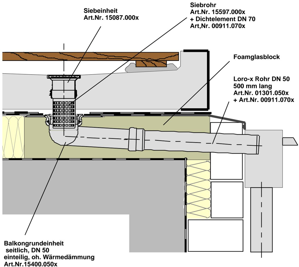
Die Balkongrundeinheit sollte in einem Foamglasblock eingefasst werden, um eine ausreichende Standsicherheit des Ablaufes zu erzielen, Weiterhin ist das Siebrohr von Estrich freizuhalten.
